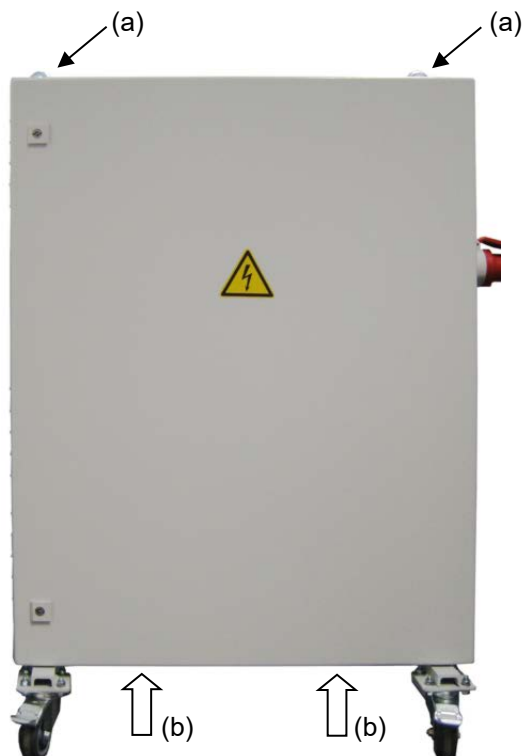
Abbildung 11: Positionierung von Hilfsmitteln zum Anheben des Spannungs- und Frequenzumwandlers
