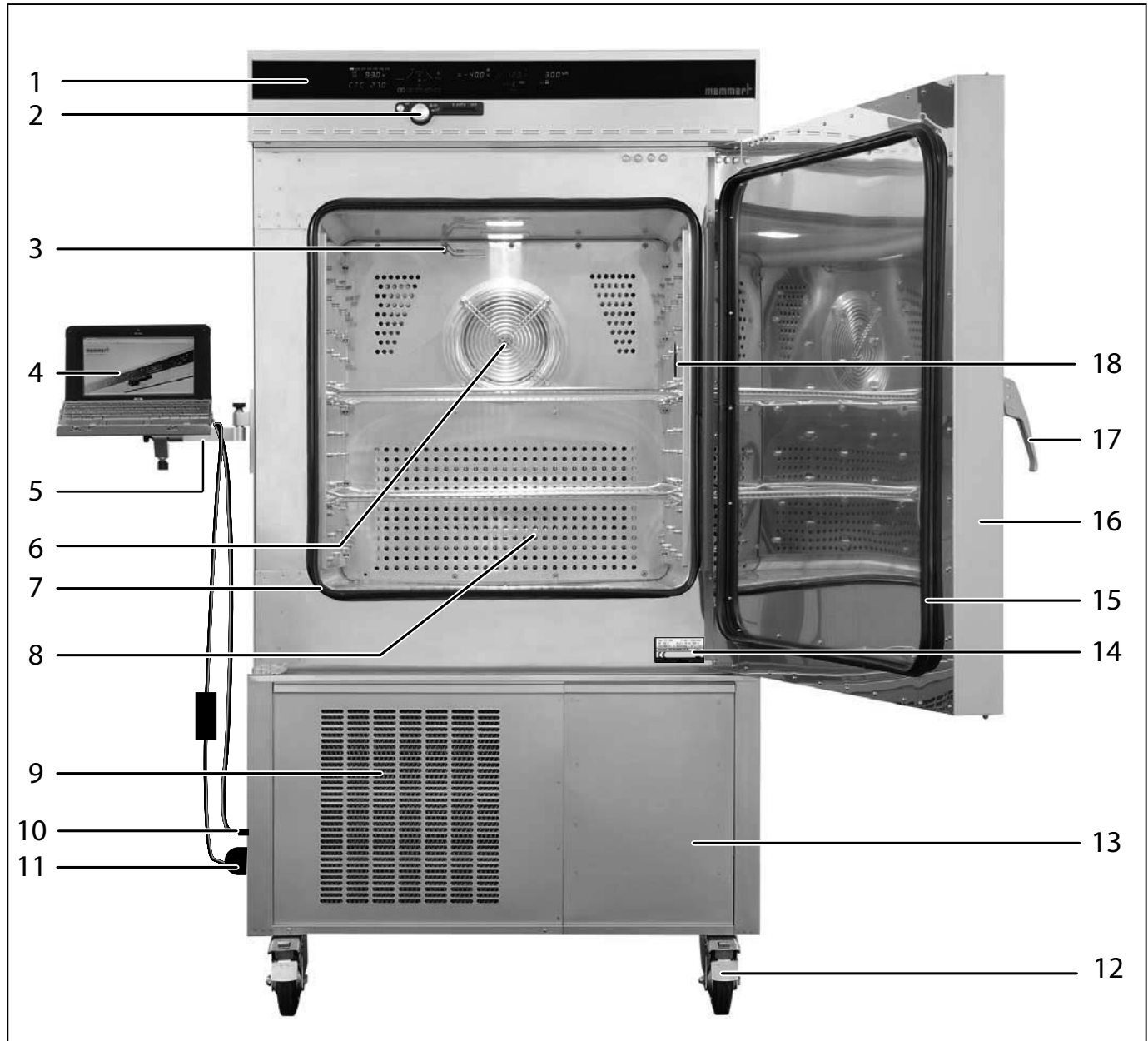
Abb. 3 Aufbau von Temperaturprüfschränken TTC und Klimaprüfschränken CTC
