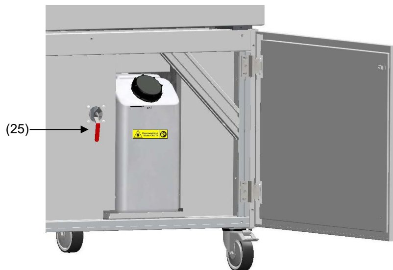
Abbildung 11: Hebel zur Rückführung des Kondensats (Position geöffnet) neben dem Frischwasserkanister hinter der Wartungsklappe
