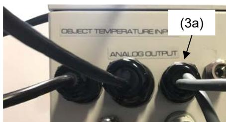
Abbildung 29: Anschlusskabel am Anschluss „Object temperature input“ (3a)
