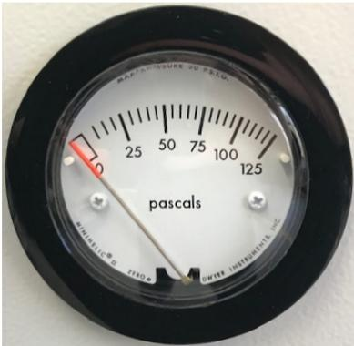
Abbildung 23: Analoge Druckanzeige (Manometer) zur Überwachung der Druckluftspülung an der Gerätefront
