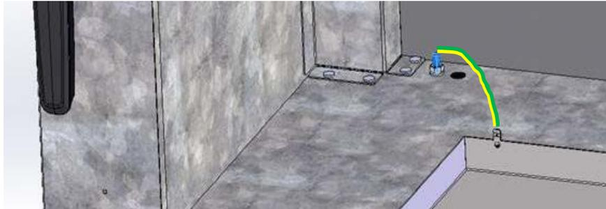
Abbildung 19: Erdungskabel zum Potenzialausgleich zwischen Kondensat-Auffangwanne und Pumpenschrank
